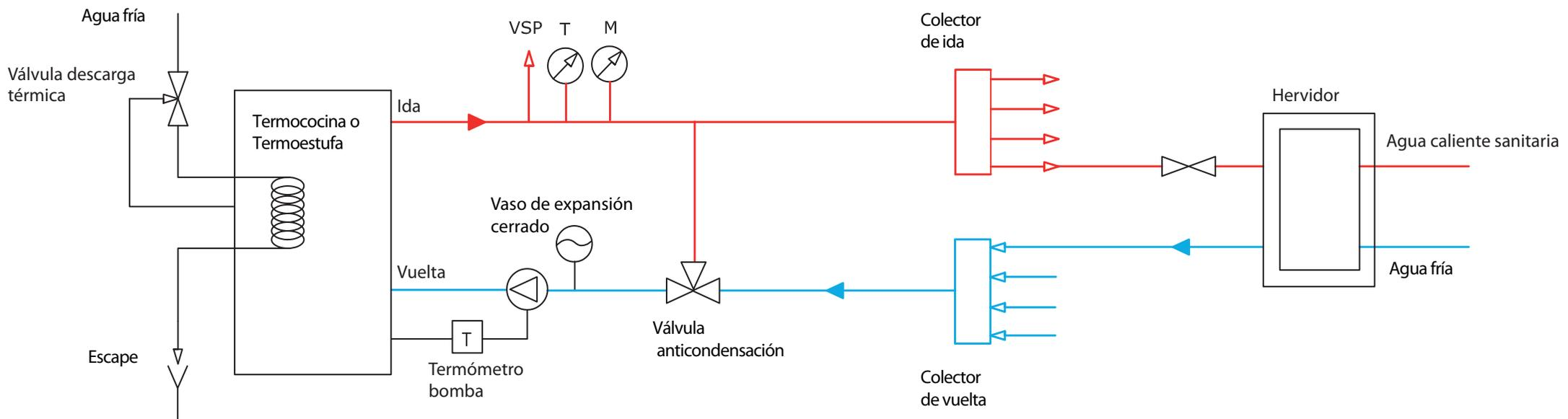
M= Manómetro VSP= Válvula de sobrepresión T= Termómetro
